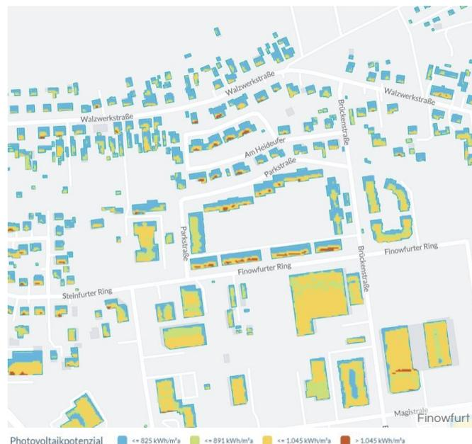
Abbildung 13: Dachflächen Photovoltaik Potential, Ausschnitt Finowfurt
