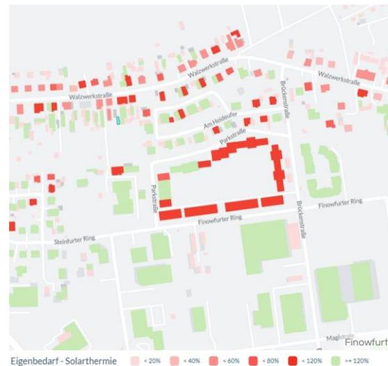
Abbildung 15: Dachflächen Solarthermie Deckung des Eigenbedarfs, Ausschnitt Finowfurt
