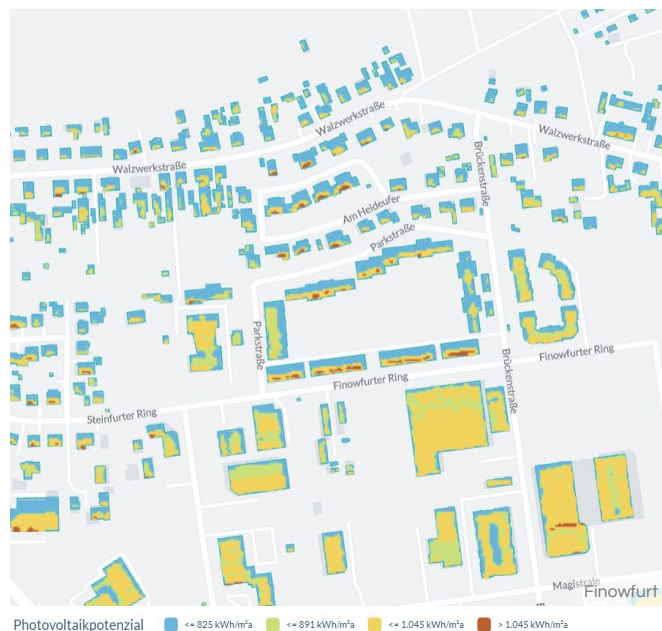
Abbildung 14: Dachflächen Photovoltaik Potential, Ausschnitt Finowfurt
